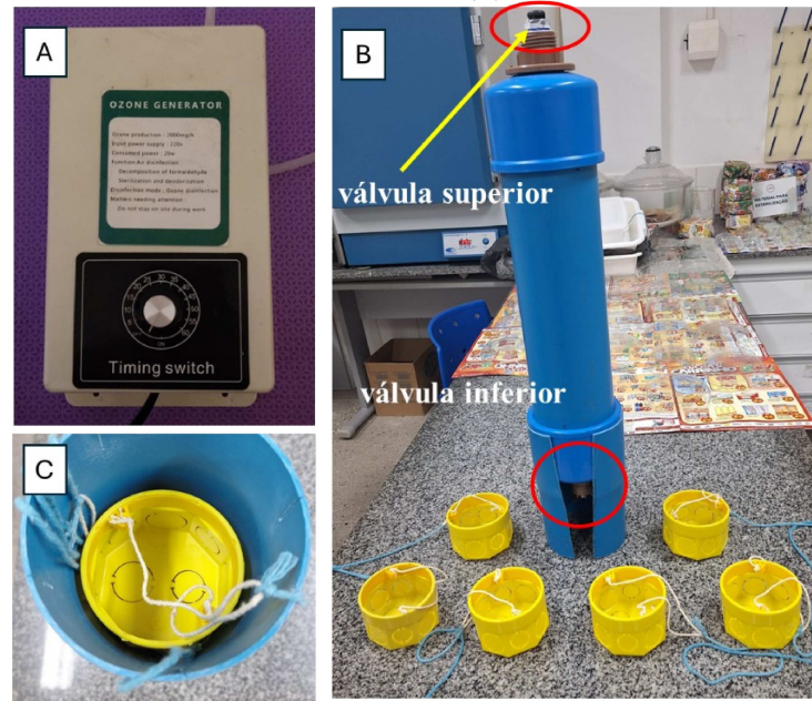
Figura 4 - Gerador de ozônio ( O_3 ) (A). Visão interna do reator(B). Visão externa do reator com cestas para as sementes(C).
