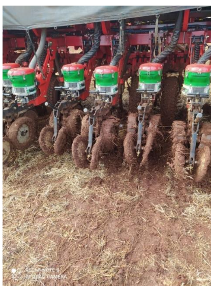
Figura 13: Rodas compactadoras com excesso de solo.
