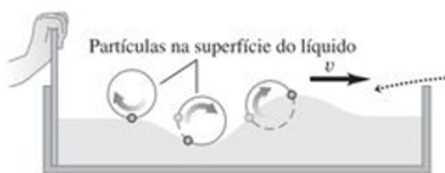
Figura 10: Propagação de perturbação ondulatória.
