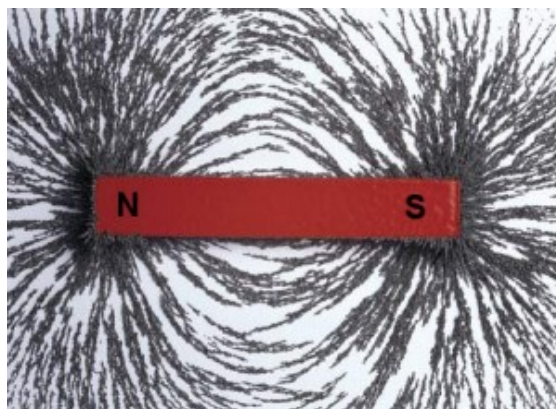
Figura 03: Limalha de ferro orientado no campo magnético produzido por um ímã de barra.
