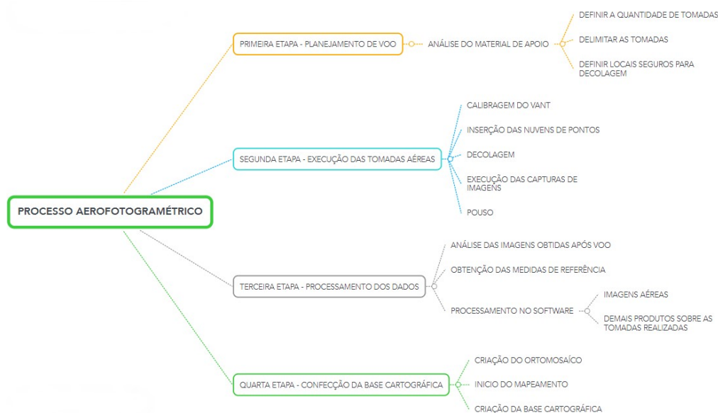
Figura 50: Fluxograma referente ao processo aerofotogramétrico.
