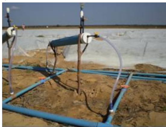
Figura 9. Equipamentos utilizados para aplicação dos fertilizantes: solução estoque preparada (A); utensílios utilizados para transferência da solução estoque (B); detalhe de manômetro, registros e tanques de derivação utilizados para aplicação da solução nutritiva (C e D)
