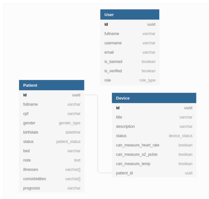
Figura 4: Modelagem relacional das informações armazenadas no servidor.
