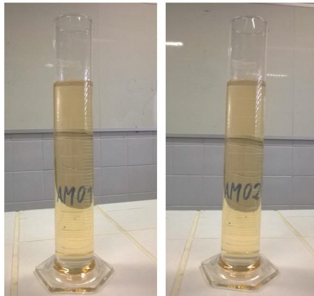
Figura 1. Ensaio para a determinação do aspecto e cor das amostras de gasolina.
