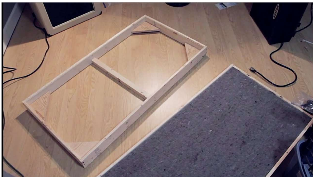
Figura 20 – Montagem de uma placa acústica com madeira e lã de rocha
