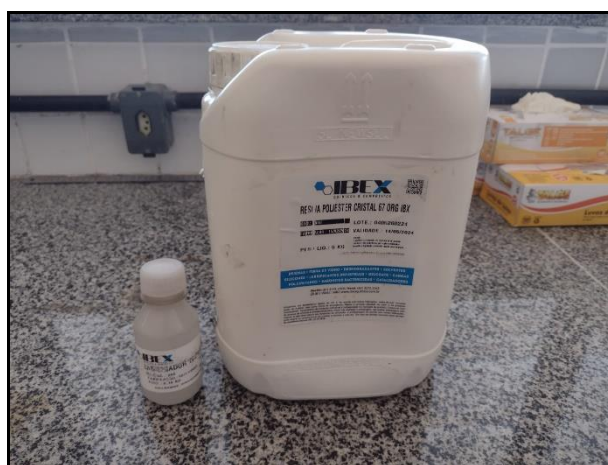
Figura 5 - Resina poliéster e catalisador utilizados.
