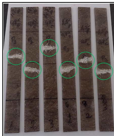
Figura 22 - Ruptura dos corpos de prova de PRFV + 1,5% PS após ensaio de tração.
