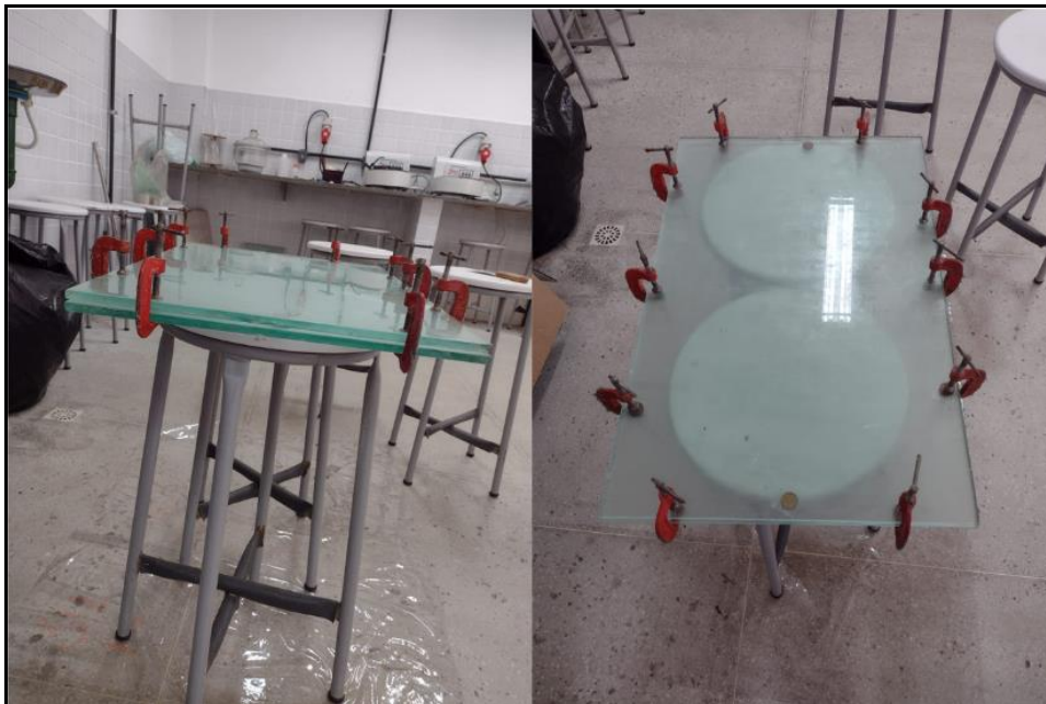
Figura 9 - Montagem e distribuição dos grampos no molde.
