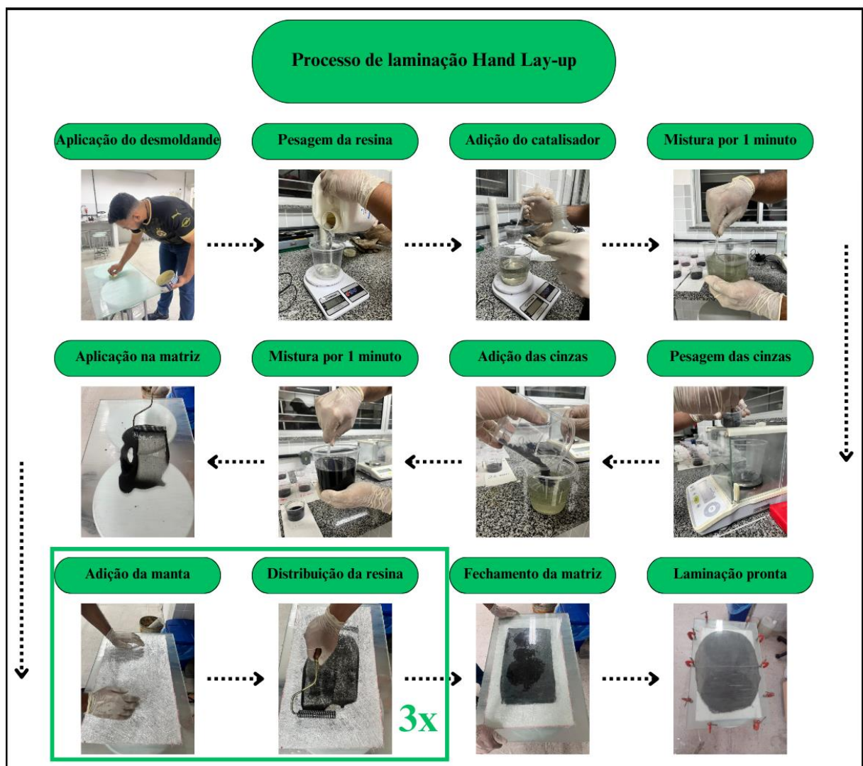
Figura 10 - Apresentação do processo de laminação Hand Lay-up.
