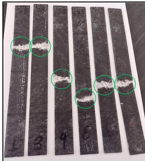
Figura 28 - Ruptura dos corpos de prova de PRFV + 1,5% EC após ensaio de tração.
