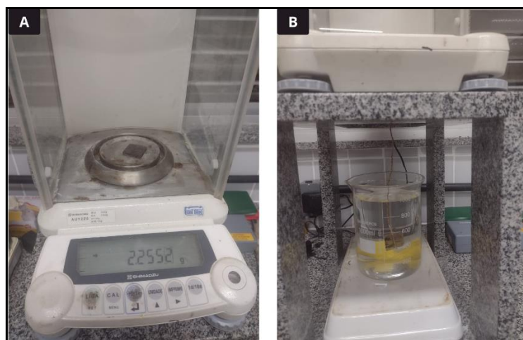
Figura 12 - (A) Pesagem dos corpos de prova e (B) Ensaio de densidade volumétrica.
