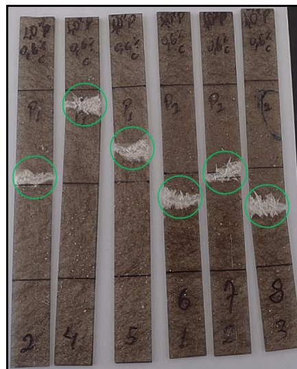
Figura 19 - Ruptura dos corpos de prova de PRFV + 1,0% PS após ensaio de tração.
