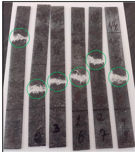
Figura 25 - Ruptura dos corpos de prova de PRFV + 1,0% EC após ensaio de tração.
