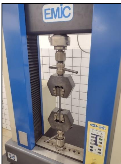
Figura 13 - Máquina de ensaio universal EMIC utilizada no teste de tração.
