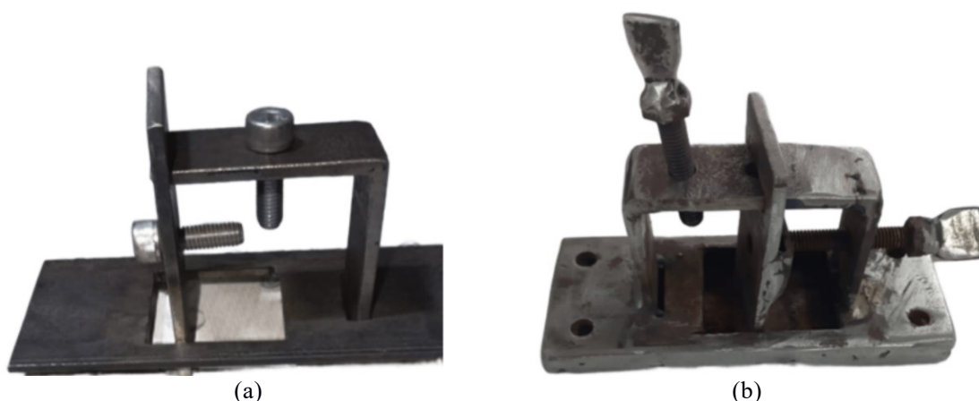
Figura 9. Construção do protótipo, processo de moldagem (a), finalização do equipamento (b). (Autoria própria, 2025)
