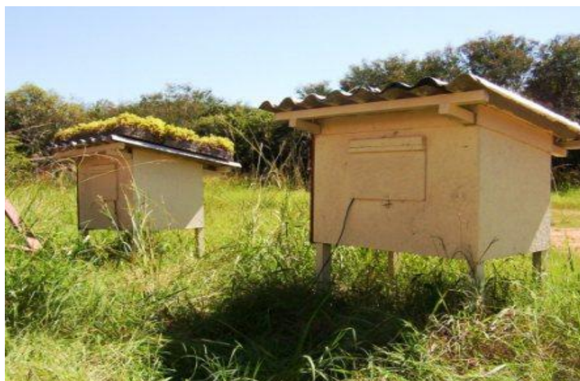
Figura 19: Protótipos com telhados verde e convencional.
