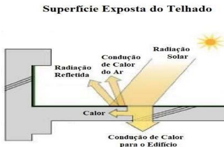
Figura 5: Radiação solar em telhado convencional
