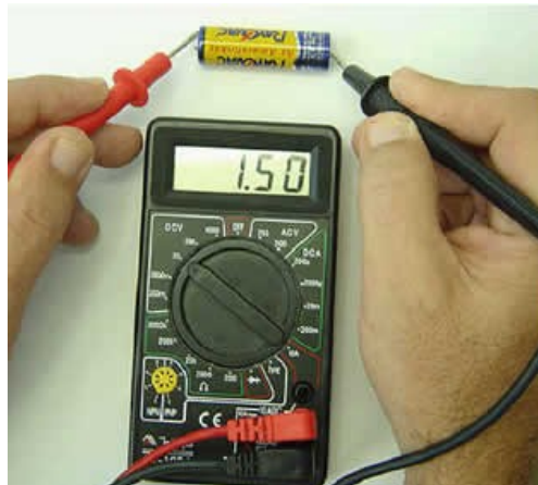
Figura 57 - Medindo a tensão de circuito aberto da pilha
