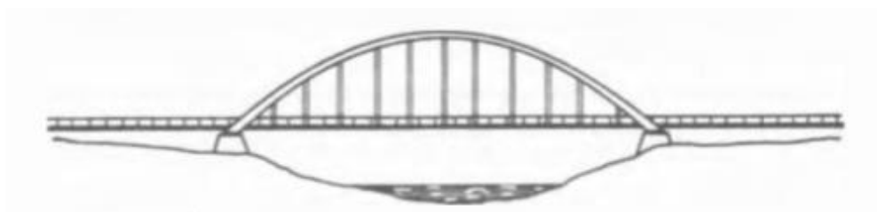
Figura 25– Ponte em arco superior
