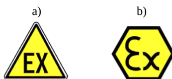
Figura 1 - Simbologia para Áreas Classificadas. a) Simbologia para área; b) Simbologia para equipamento [3].
