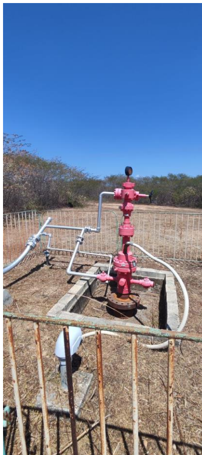
Figura 2. Bombeio centrífugo submerso. (Autoria própria)
