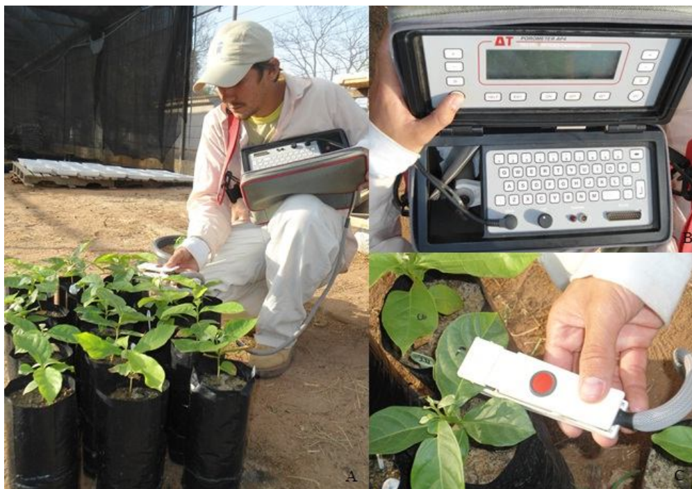
Figura 16 - Medidas de condutância estomática; A) Rivanildo medindo condutância nas plantas; B) detalhes do porômetro; C) detalhe da folha amostrada. Fonte: Fotos e montagem de Gabrielly Henriques.
