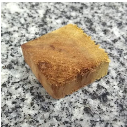
Figura 2. Corpo de prova de Sabiá com dimensões 2,5x2,5x1 cm
