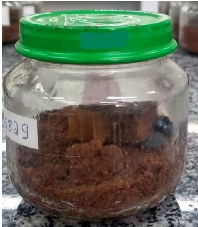
Figura 4. Ensaio acelerado para averiguar a resistência da madeira das espécies.
