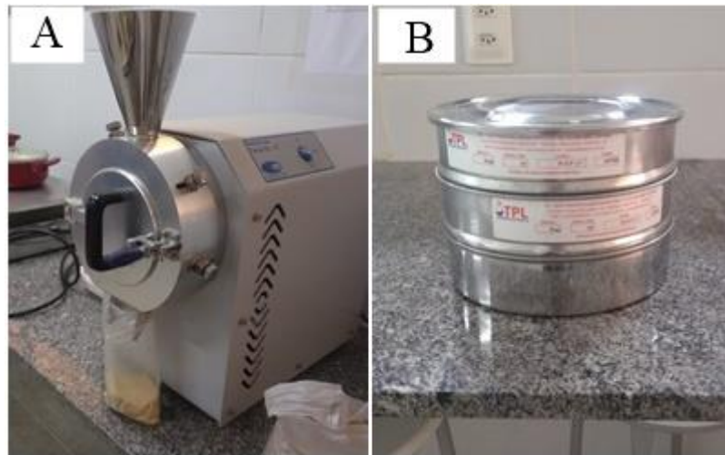
Figura 5. Procedimento de preparo das amostras: A- Moinho de facas B- Peneiras de 40 e 100 mesh.
