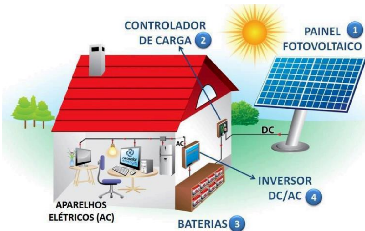
Figura 5 - Sistema Off-Grid (Isolado)
