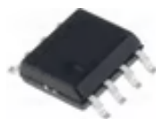
Figura 3 – Exemplo Microcontrolador Attiny13a SMD
