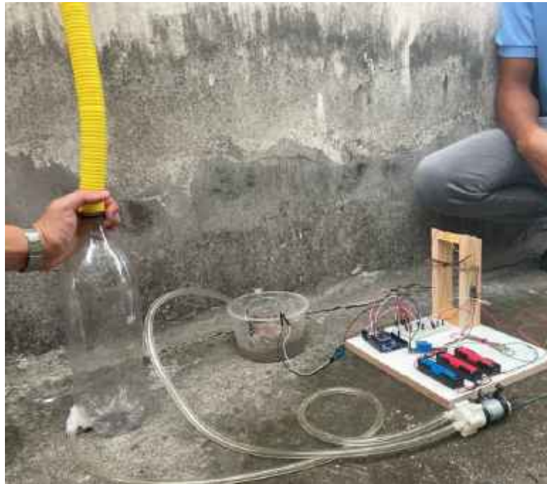
Figura 13 – Teste prático do protótipo de irrigação automática utilizando água de condensação
