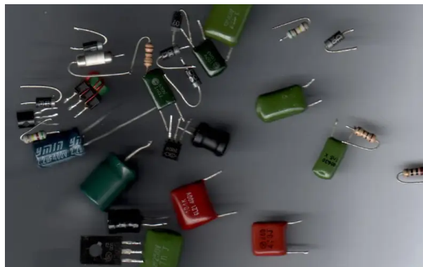
Figura 1 – Exemplo genérico de Componentes THT
