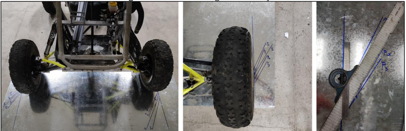
Figura 24 - Teste do ângulo de esterçamento.
