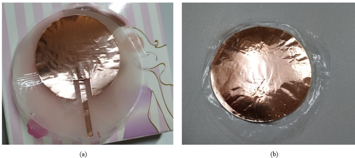
Figura 11 – Protótipo com Patch e Ground . (a) Vista inferior; (b) Vista superior.
