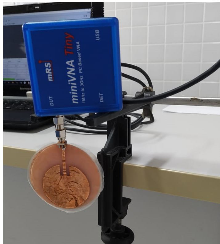
Figura 15 – Detalhamento da Antena e do MiniVNA .
