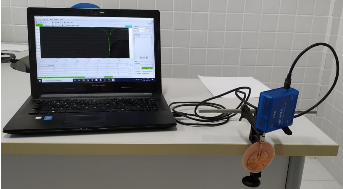
Figura 14 – Realização do teste da Antena Banda Estreita.
