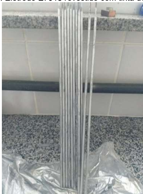
Figura 5: Eletrodo E7018 revestido com tinta de alumínio
