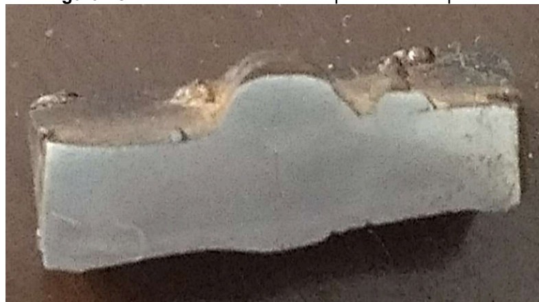
Figura 18: Amostra dureza vickers para eletrodo pintado
