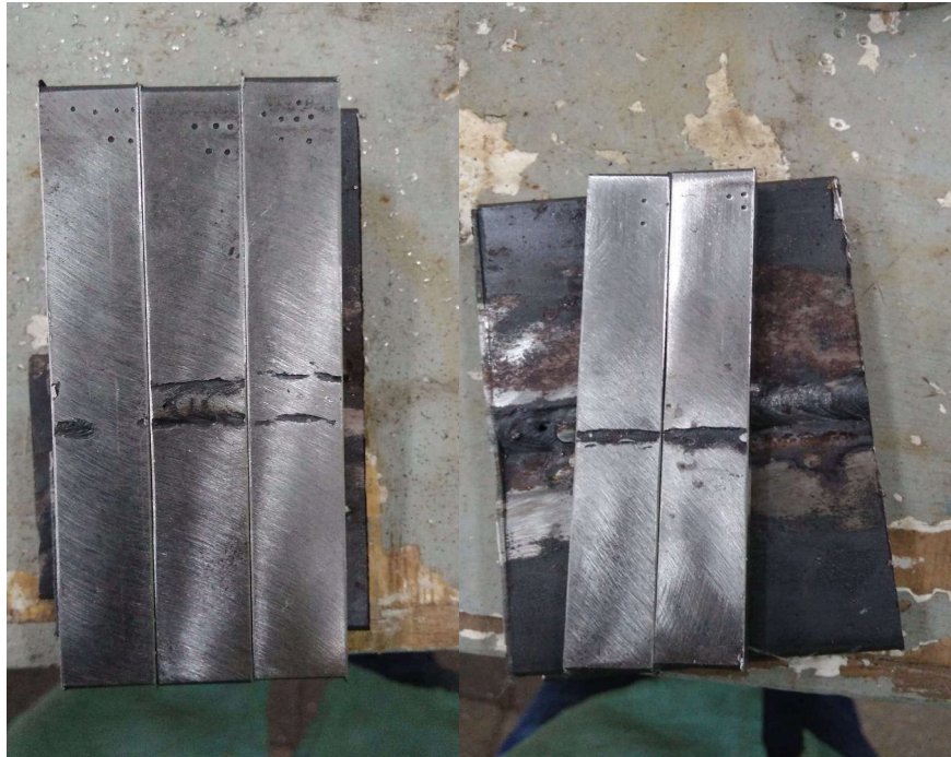
Figura 11: Usinagem para a preparação do ensaio de dobramento (a) exposta ao ambiente, (b) modificado com tinta
