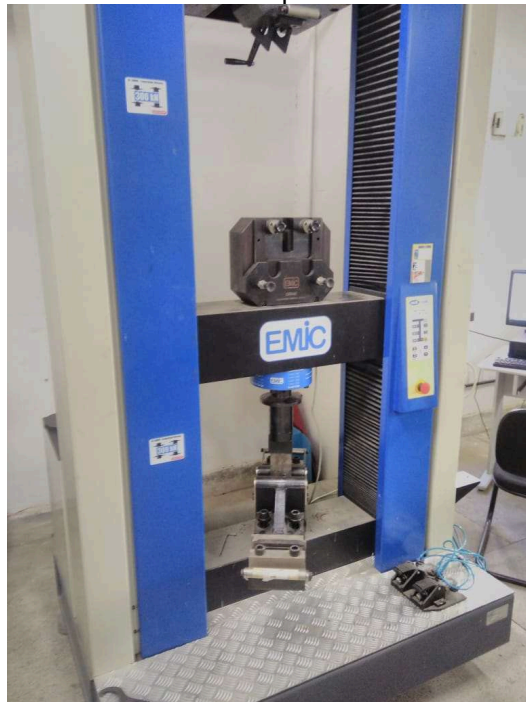
Figura 10: Prensa mecânica para ensaio de dobramento
