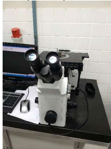
Figura 9: Microscópio usado para análise metalográfica
