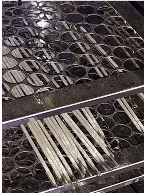
Figura 4: Eletrodos E7018 na estufa
