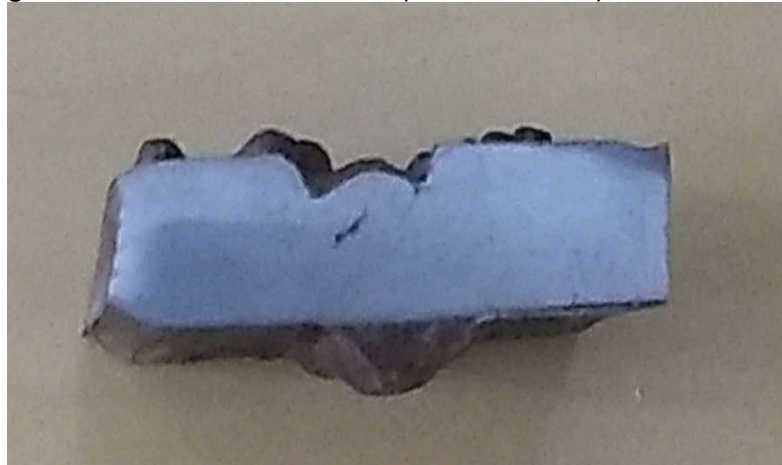
Figura 17: Amostra dureza vickers para eletrodo exposto ao ambiente
