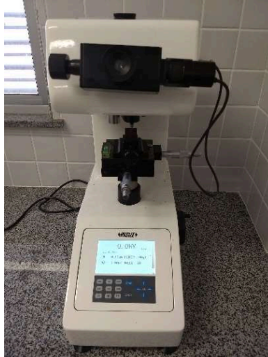
Figura 7: Microdurômetro para testes de dureza
