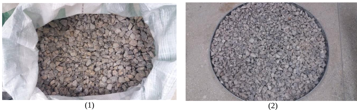
Figura 4 – Agregados graúdos utilizados: (1) Brita e (2) ARC de concreto.
