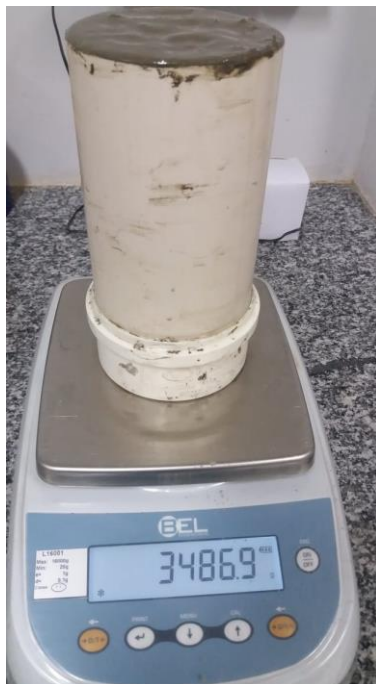
Figura 10 – Determinação da massa específica do concreto fresco.
