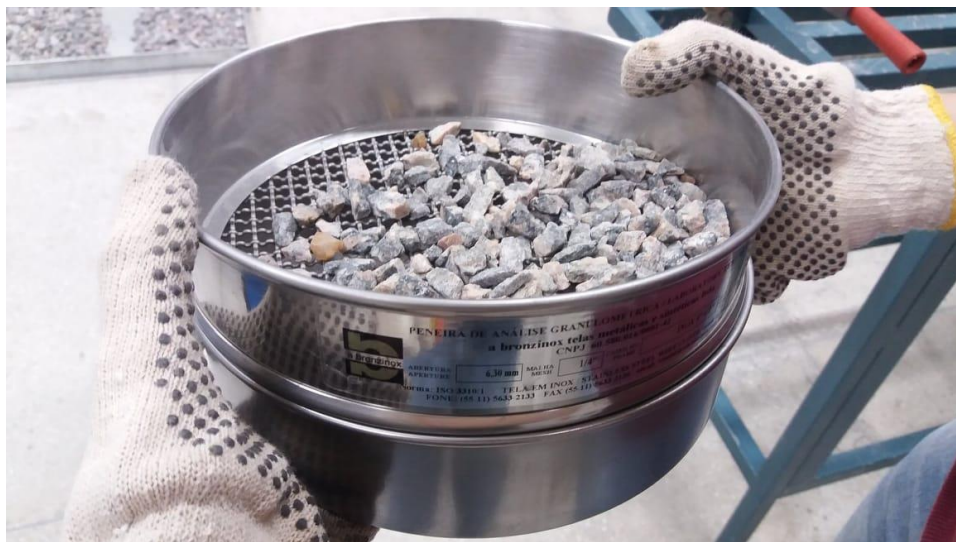
Figura 7 – Ensaio de granulometria com a brita.
