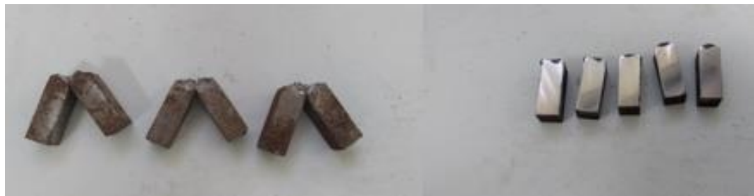
Figura 21: Estado superficial dos corpos de prova antes e depois da limpeza
