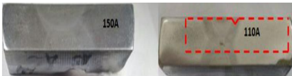
Figura 20: Macrografias dos corpos de prova com diferentes energias de soldagem.
