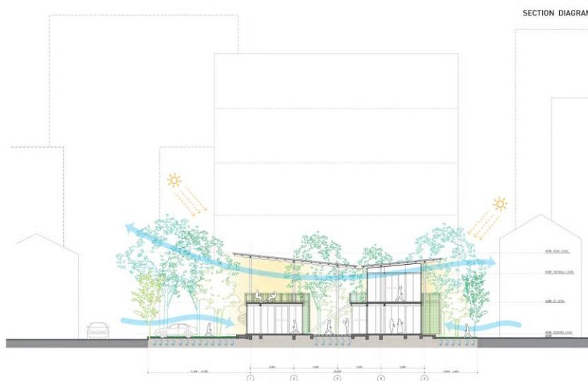
Figura 19: Corte esquemático de ventilação e insolação
