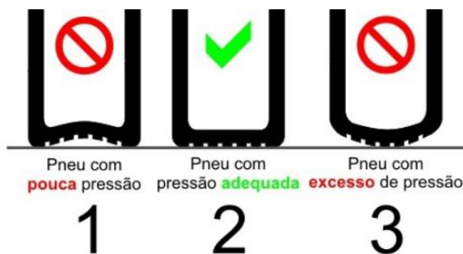
Figura 14 - Efeito da pressão na parte da borracha do pneu que toca o solo
