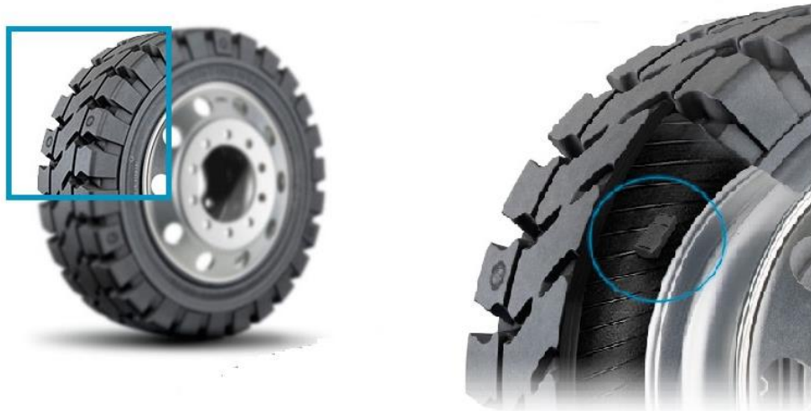
Figura 8 - Sensor instalado na parte interna do pneu
