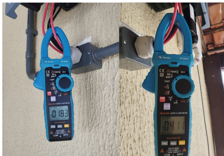
Figura 11. Ensaio de corrente durante períodos de sombreamento. (Fonte: Autor).
