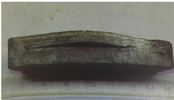
Figura 27 - Empolamento por hidrogênio em chapa \frac{3}{4} " ASTM A 516 Gr. 60
