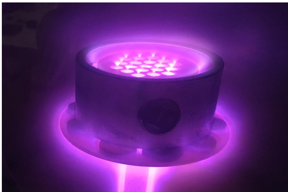
Figura 36 - Vista superior do plasma formado na Gaiola Catódica no tratamento a pressão de 1,5 mbar
