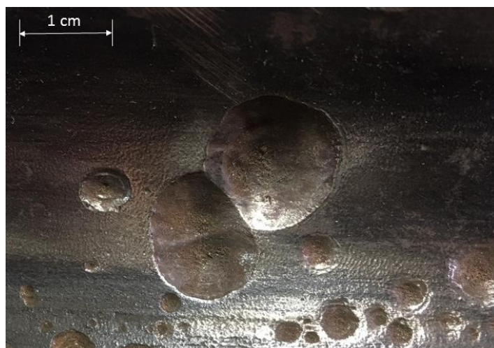
Figura 23 - Corrosão alveolar em superfície interna de tubo API 5L Gr B – superfície escovada
