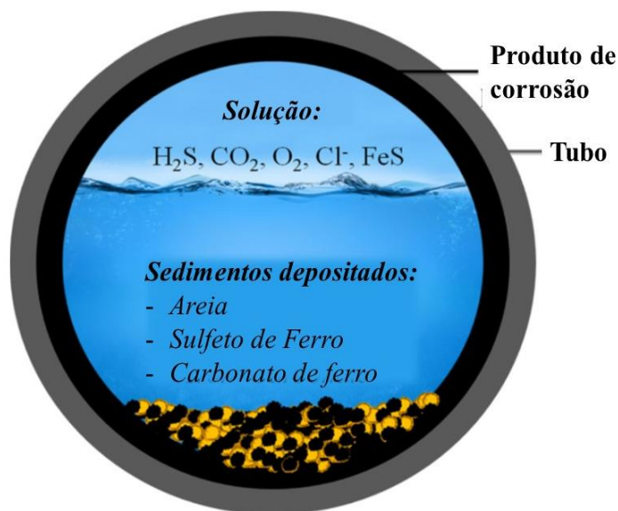
Figura 28 - Esquema da corrosão em um meio contendo \text{H}_2\text{S} – \text{CO}_2 – \text{H}_2\text{O} – \text{O}_2 – \text{Cl}^- – \text{FeS}
