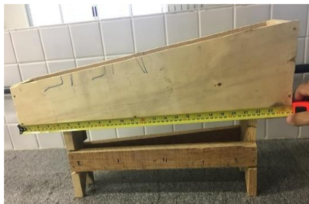
Figura 12 - Apoio de madeira para sustentação do canal.
