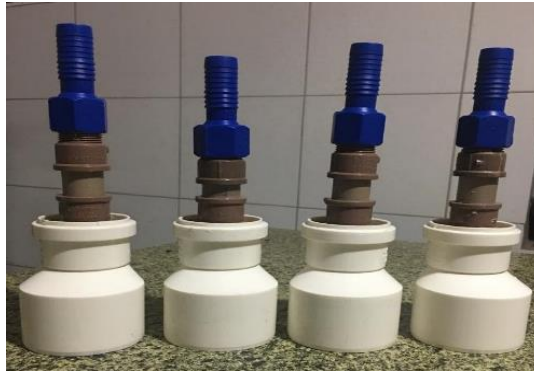
Figura 9 - Adaptadores para coleta de água nas saídas laterais.
