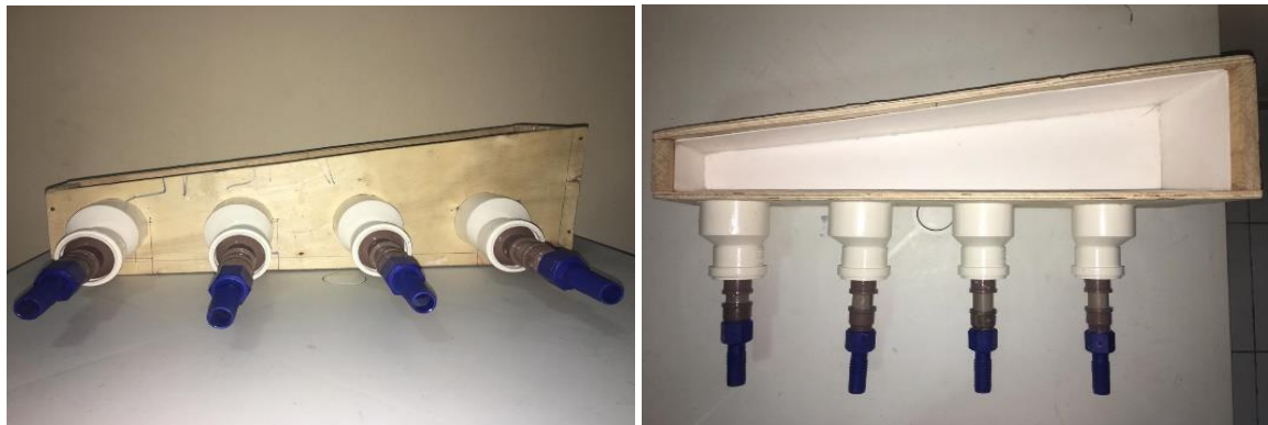
Figura 14 - Aparato experimental de canal de distribuição de água: (a) Vista lateral e (b) Vista superior do canal.
