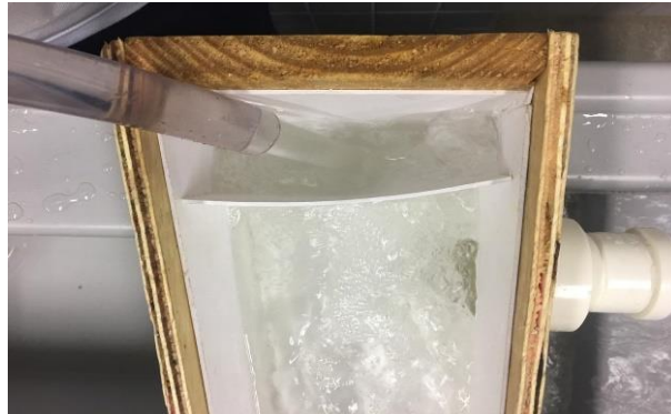
Figura 19 - Canal com presença de dissipador de energia.
