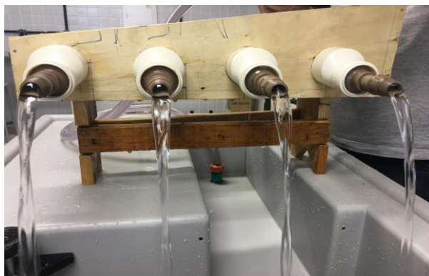
Figura 17 - Seção plena em cada saída lateral.
