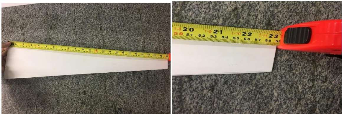
Figura 10 - Corte do fundo do canal de distribuição de água: (a) Medição do comprimento e (b) Aproximação do valor medido na trena.
