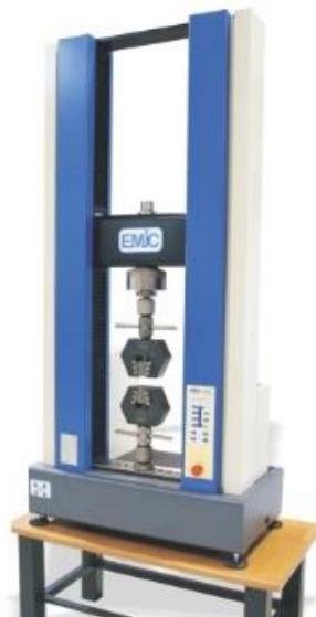
Figura 18: Máquina Universal de Ensaio DL 10000 EMIC.
