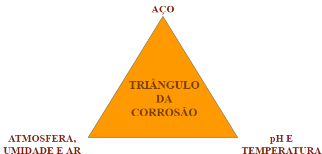
Figura 15: Triângulo da Corrosão no Ambiente.
