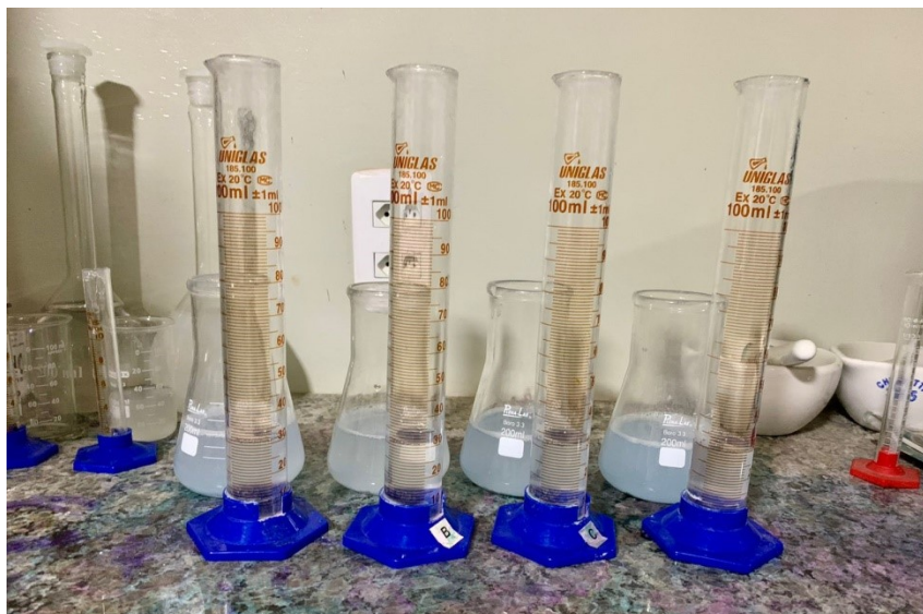
Figura 13: Experimento para determinação da espumação em amostras de sabão em pó.
