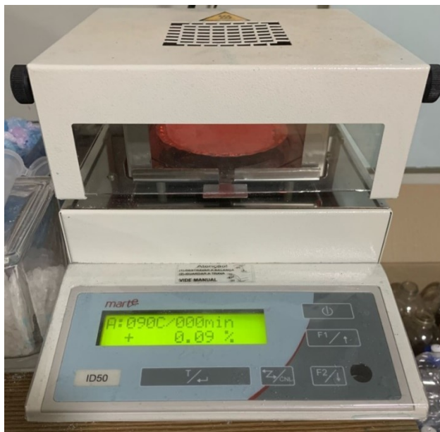
Figura 12: Balança determinadora de umidade utilizada na empresa.
