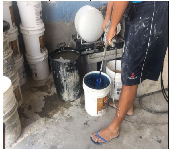
Figura 4 - Compressor (esquerda) e processo de mistura para fabricação do aditivo.
