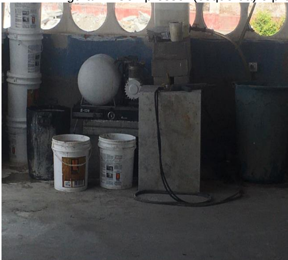
Figura 4 - Compressor (esquerda) e processo de mistura para fabricação do aditivo.
