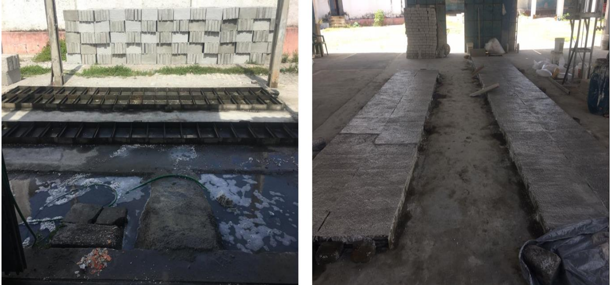
Figura 5 - Processo de cura (Secagem), dos blocos de BCCA.
