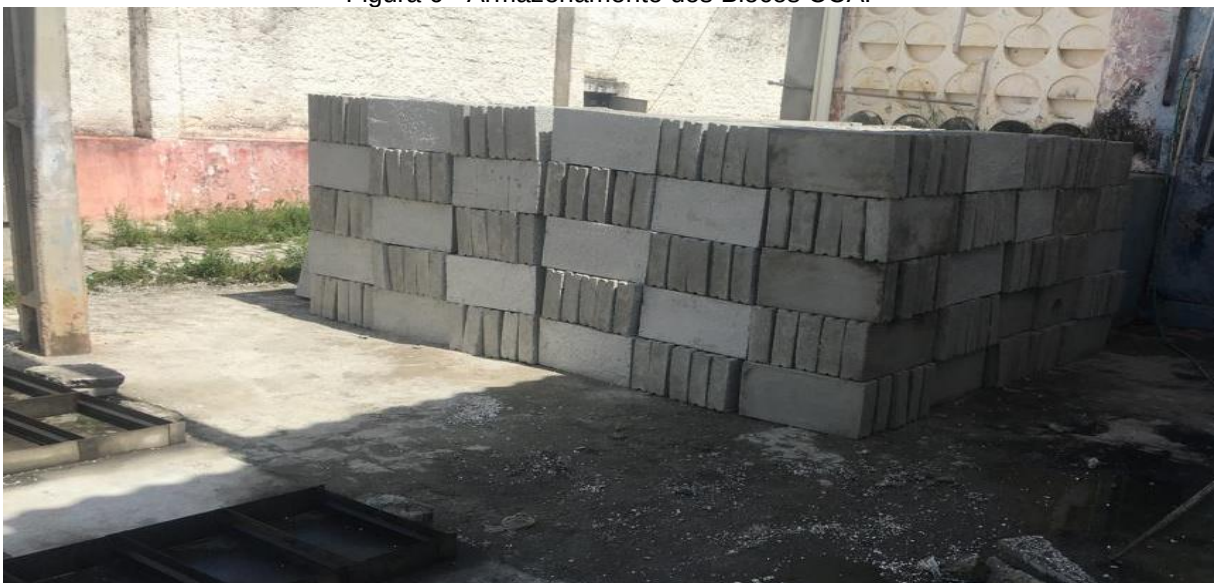
Figura 6 - Armazenamento dos Blocos CCA.
