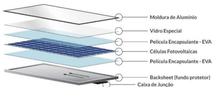
Figura 9: Componentes usados na composição dos painéis solares.
