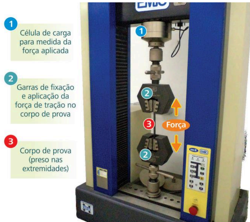
Figura 11: Esquemático de ensaio de tração uniaxial.
