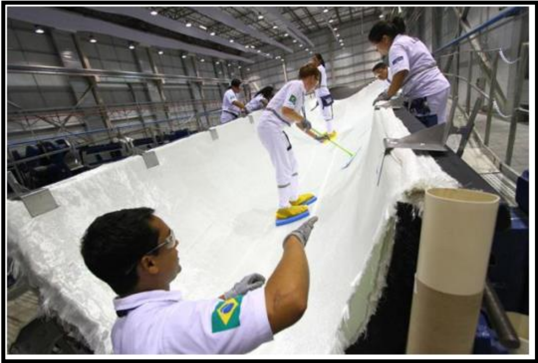
Figura 10: Processo de laminação manual ( Hand Lay-Up ).
