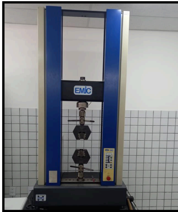
Figura 29: Máquina universal DL-10000, da EMIC com célula de carga de capacidade máxima de 30 KN.
