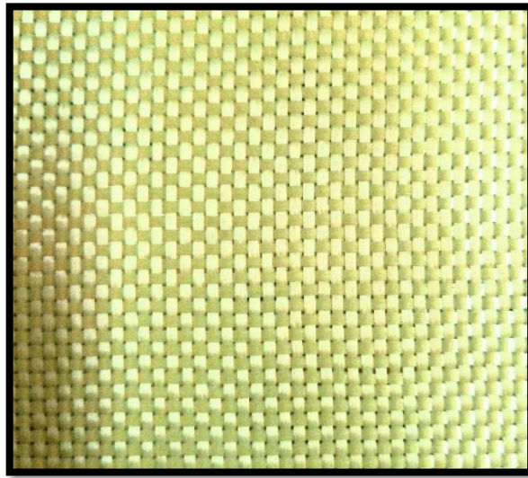
Figura 16: Tecido bidirecional 1x1 de fibra de aramida Twaron D2200.
