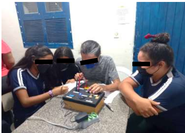
Figura 26 - alunos realizando as medidas para obtenção da constante de Planck
