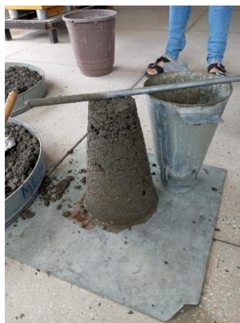
Figura 19 - Abatimento do concreto
