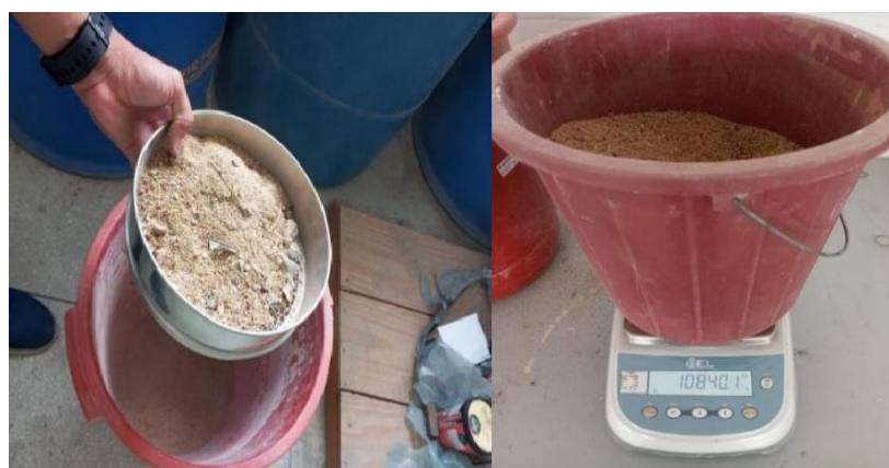
Figura 6 - (a) Peneiramento e (b) Pesagem dos agregados miúdos
