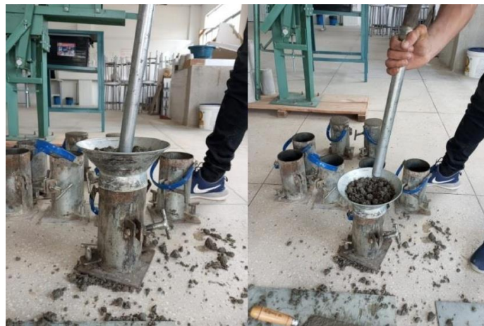
Figura 15 - (a) Moldagem dos corpos de prova e (b) Adensamento com vibrador mecânico
