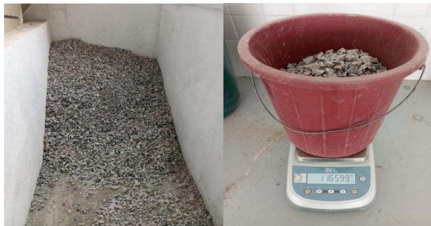
Figura 7 - (a) Captação e (b) Pesagem dos agregados graúdos
