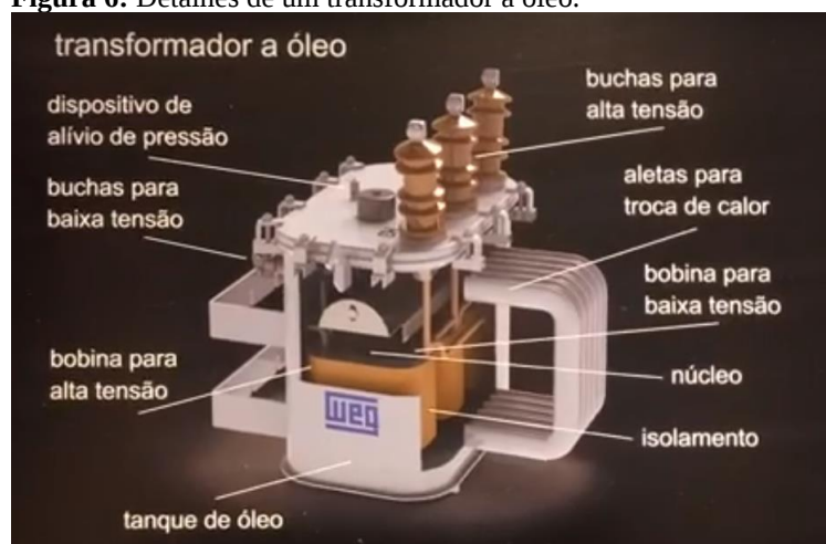
Figura 6: Detalhes de um transformador a óleo.
