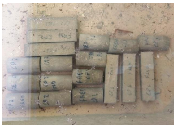
Figura 14 – Corpos de Prova Desmoldados em Processo de Cura.
