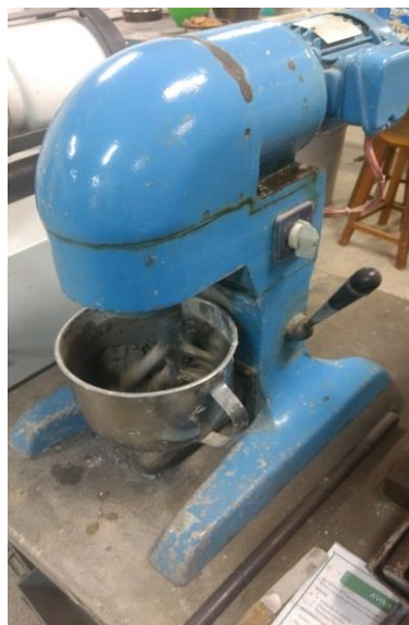
Figura 9 – Argamassadeira Usada Para Mistura dos Materiais.
