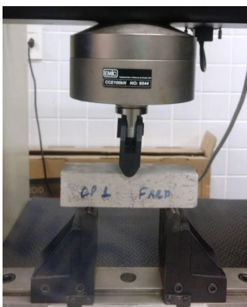
Figura 16 – Ensaio de Resistência à Tração na Flexão.
