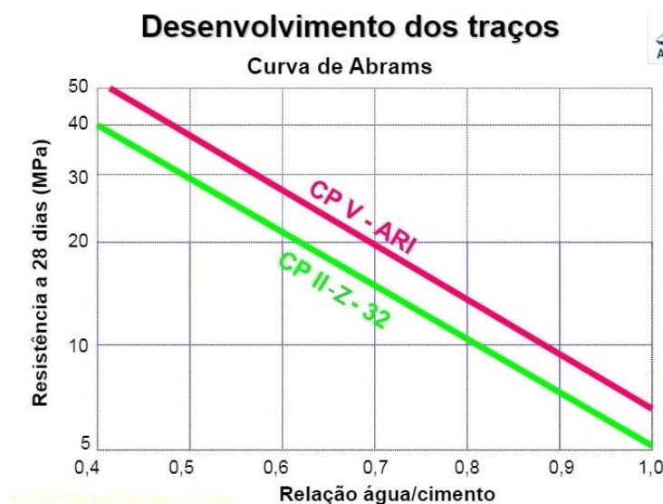
Figura 21: Relação Água/Cimento Para Cada Amostra Estudada.
