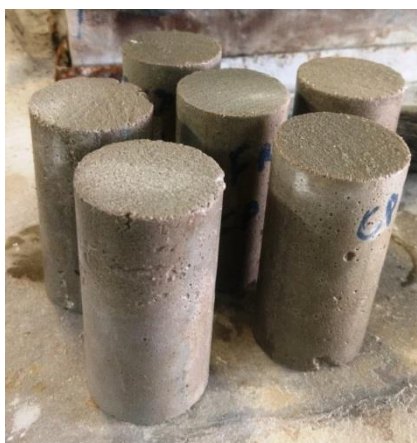
Figura 17 – Corpos de Prova Após Capeamento em Retífica.
