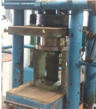
Figura 18 – Ensaio de Resistência à Compressão em Corpos de Prova Cilíndricos.
