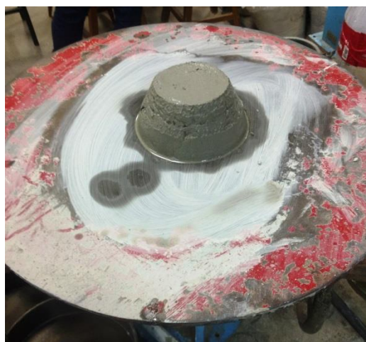
Figura 10 – Moldagem de Tronco de Cone.
