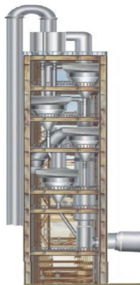
Figura 9 – Pré-aquecedor/Torre de ciclone. FONTE: (PATFAB ENGINEERS PVT. LTD, 2010) [9]
