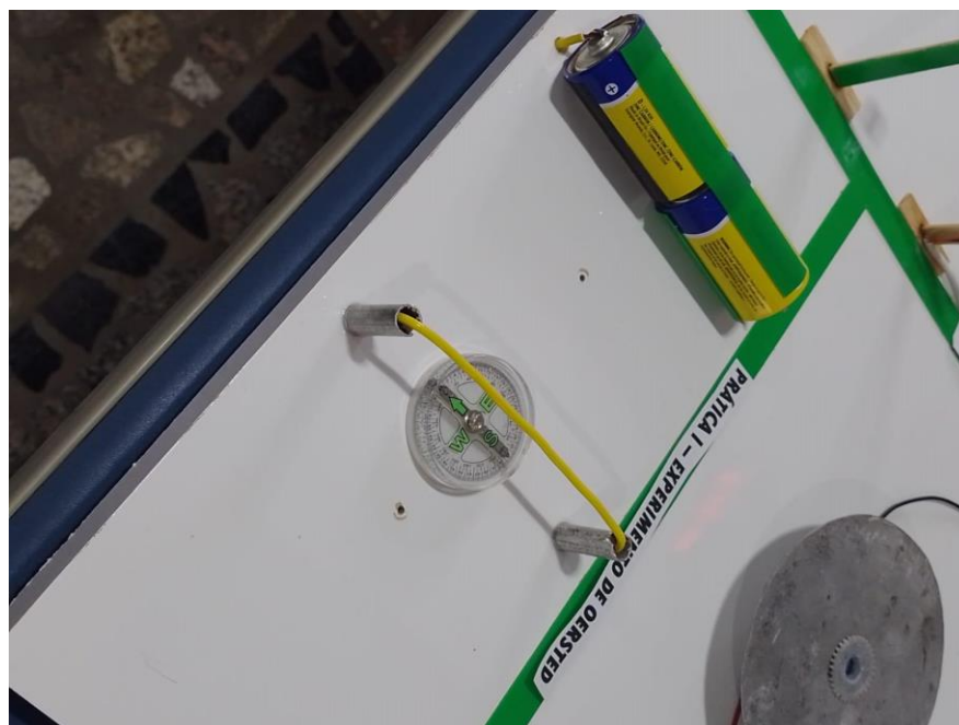
Figura 06: Agulha da bússola paralela à direção da corrente. Fonte: Autor, 2021.
