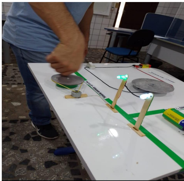
Figura 20: Teste de funcionamento do Gerador Manual. Fonte: Autor, 2021.
