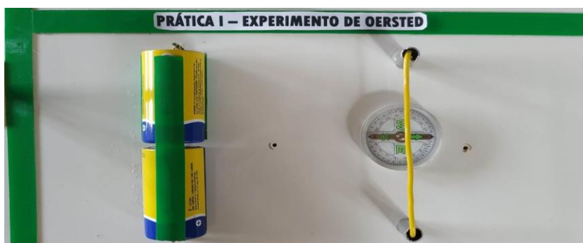
Figura 05: Experimento de Oersted e a bússola perpendicular à direção da corrente. Fonte: Autor, 2021.
