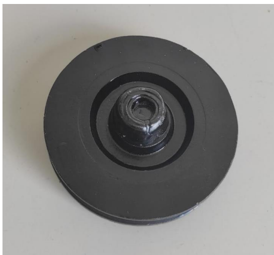
Figura 19 - Polia que será acoplada ao motor.
