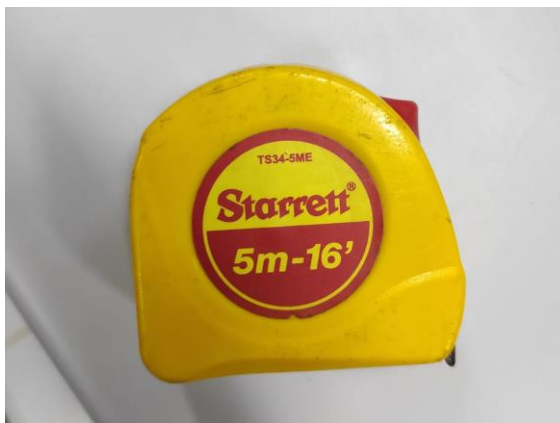
Figura 21 - Fita métrica utilizada para a medição da profundidade.
