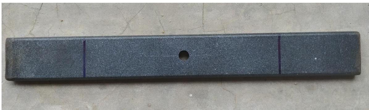
Figura 37 – Barra chata 1"x1/4 utilizada no ensaio de tração.
