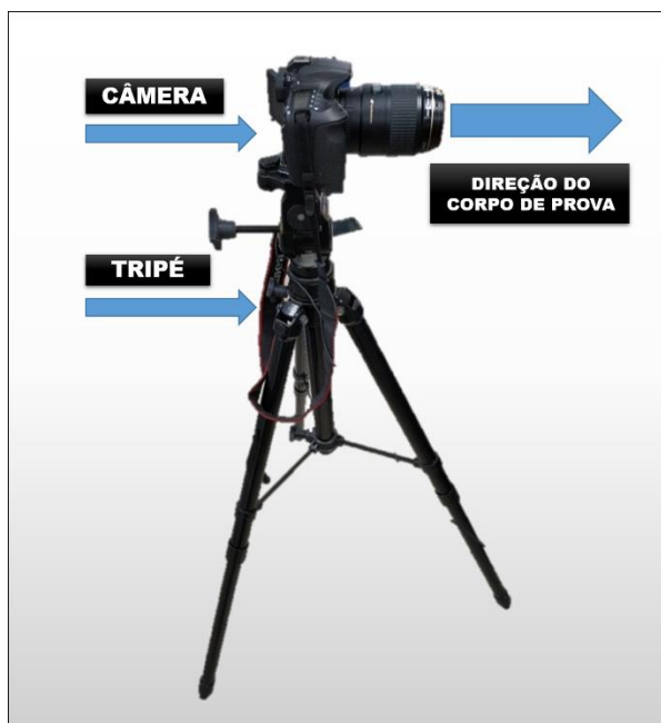
Figura 33 – Armação da câmera Canon® EOS 60D no tripé.
