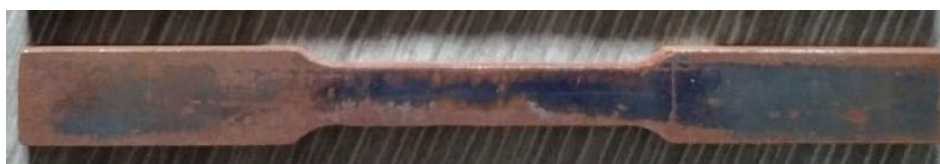
Figura 39 – Corpo de prova usinado antes de receber a descontinuidade no centro.
