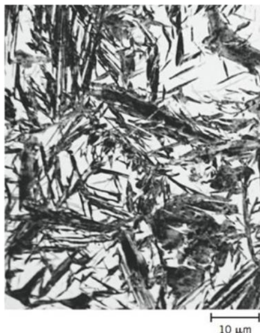
Figura 4. Fotomicrografia mostrando a microestrutura martensítica. [4]
