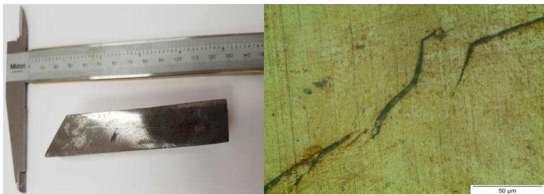
Figura 11. Imagem macroscópica e microscópica da trinca com ampliação de 500×.
