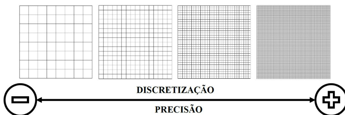
Figura 4 – Processo de refinamento da malha onde se inicia com uma malha grosseira e se chega a uma malha refinada.
