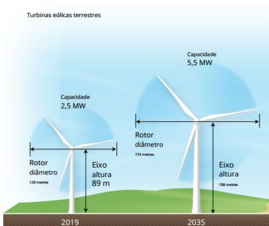
Figura 7 - Exemplo de uma turbina eólica onshore e uma estimativa do seu tamanho em 2035.
