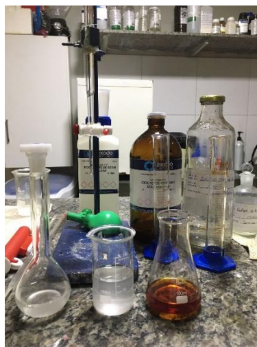
Figura 6 – Equipamento e vidrarias utilizadas para análise de cloro ativo.
