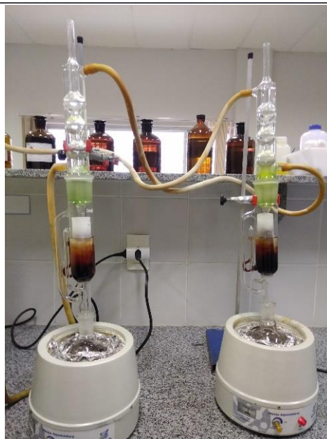
Figura 2. Extração do óleo da amêndoa por solvente etanol. (Autoria própria)
