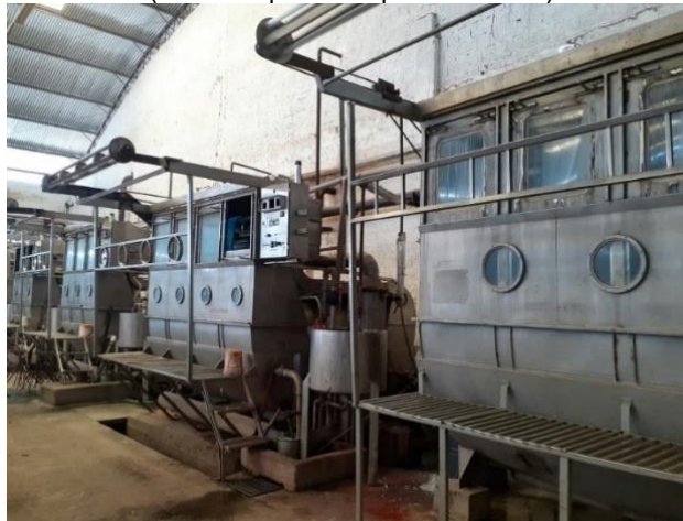
Figura 05 - Equipamento responsável pelo tingimento dos tecidos (cada máquina comporta uma cor).
