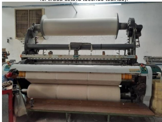
Figura 02 – Tear (no momento em que a fotografia foi tirada estava tecendo toalhas).
