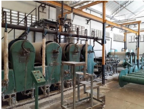
Figura 04 – Equipamento responsável pelo processo de alvejamento dos fios.
