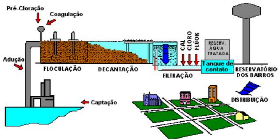
Figura 5: Estação de tratamento de água convencional.
